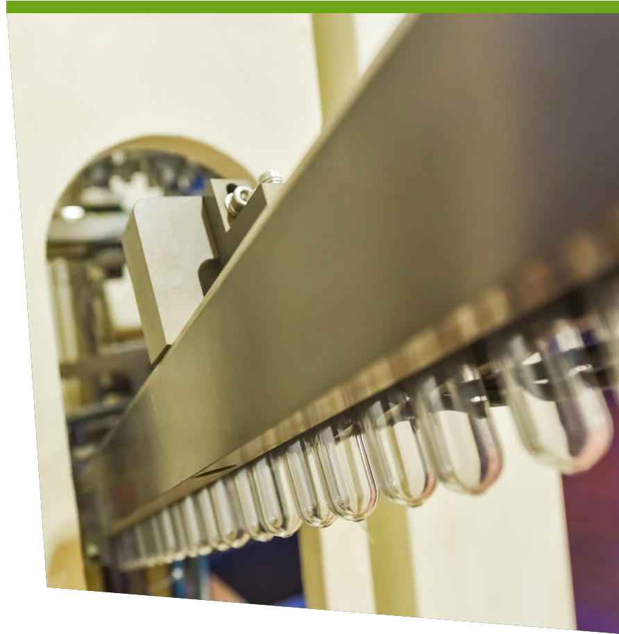
* Instalación de maquinaria para el soplado de botellas PET.
